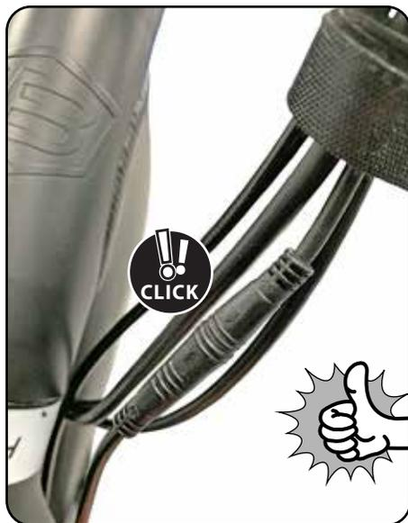
**REMARQUE :** S'assurer que les flèches (C) sur chaque connecteur sont alignées avant d'effectuer la connexion pour éviter d'endommager les connecteurs à broches.
