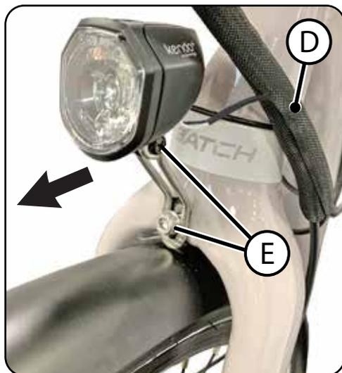
**REMARQUE :** Si la roue frotte le garde-boue après le montage, desserrer le boulon de montage (E) et régler le garde-boue autant que nécessaire. Bien serrer le boulon.
